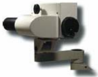
FMS III , Stimolatore con doppia telecamera per il controllo della pupilla e del fondo oculare
